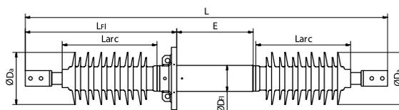
Линейный ввод. Проводник – медь. Толщина стены E=300 мм
