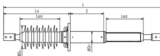
Линейный ввод. Проводник – алюминий. Толщина стены E=300 мм
